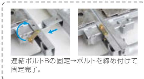
連結ボルトBの固定→ボルトを締め付けて固定完了。
