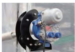
換気設備 側面換気・自動巻上
