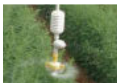
灌水設備 天井灌水(スプリンクラー)
