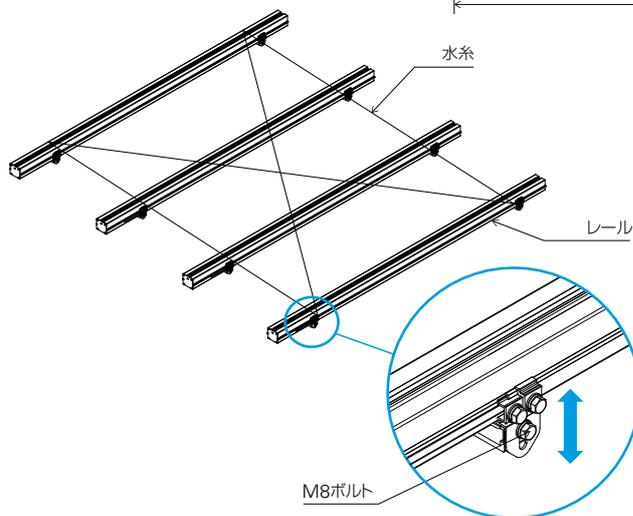
レールの不陸調整は軒先の水平レベルを合わせ水糸を張りレール受金具のM8ボルトを緩めて調整を行います。
