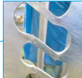
鋼製デバイスの塑性部変形の様子
