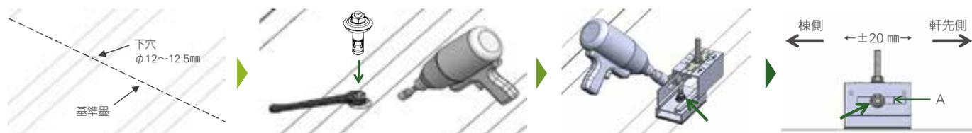
基準墨を目安に金具取付け箇所の屋根材にルーフトリルなどで、φ 12.5の下穴を加工して下さい。
