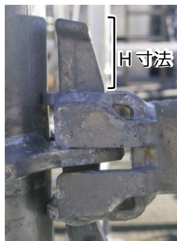
下部金具 くさび打ち込み時
